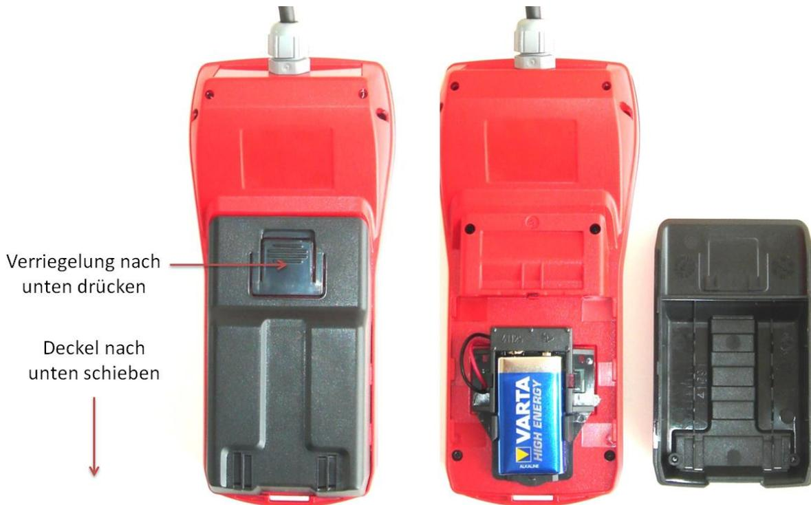
Drücken Sie den Federverschluss am Batteriefach des MOTOMETER ECT 700-Handgerätes.
